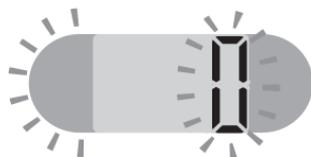
浄水カートリッジ使用残量が少なくなりましたら新しい浄水カートリッジをご準備ください。0<sup>リットル</sup>になると数字とオレンジ色のLEDが点滅しますので、新しい浄水カートリッジに交換してください。
